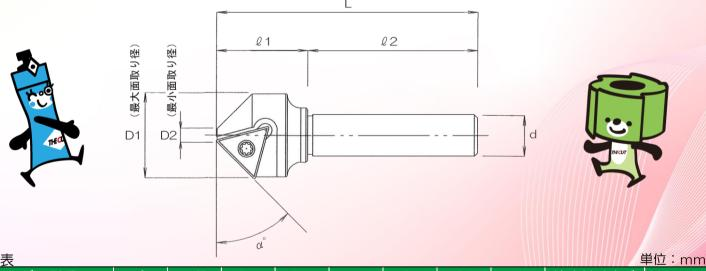
●寸法表 *Q* 2 ホルダー型番 刃数 D2 Q 1 d 締め付けネジ  $\alpha$ ° **D1** MTMB0425-S10 10 4.2 76.8 26.8 25 MTMB0425-S12 45° 1 31 78 28 50 MST-4S MFT-15 MTMB1031-S12 10 12 MTMB2041-S12 41 20 80 30 MTMB0430-120-S12 30° 30 27
