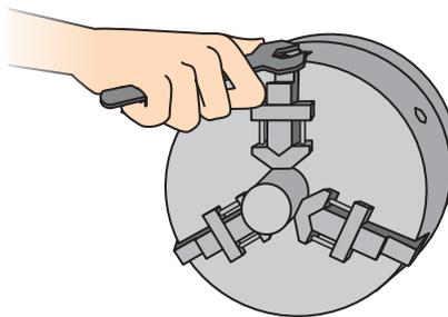
適当な丸棒をくわえて締め、密着を確めてボルトをレンチで本締めして下さい。あとはストッパーをセットして必要な寸法に削ってご使用下さい。
