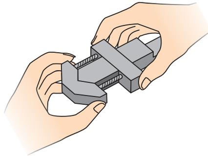
三角生爪のボルト(キャップスクリュー)をゆるめ、チャックの本爪に嵌め込んで下さい。
